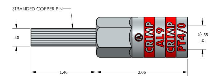
ALUMINUM COMPRESSION CONNECTOR TOOL AND DIE CHART (# OF CRIMPS)
