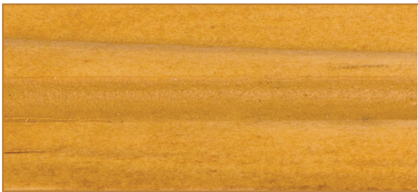
Le bois a été teint puis calfeutré avec du mastic.
