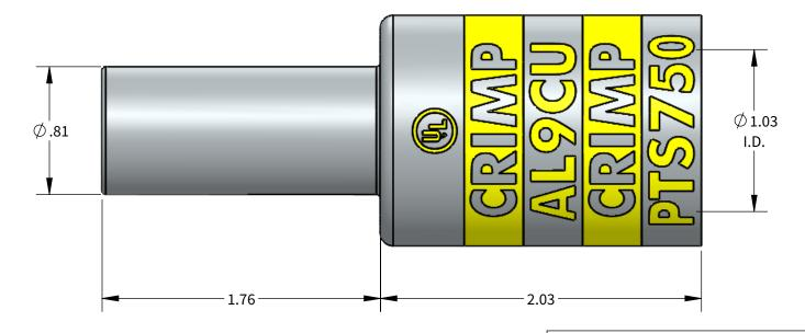
ALUMINUM COMPRESSION CONNECTOR TOOL AND DIE CHART (# OF CRIMPS)
